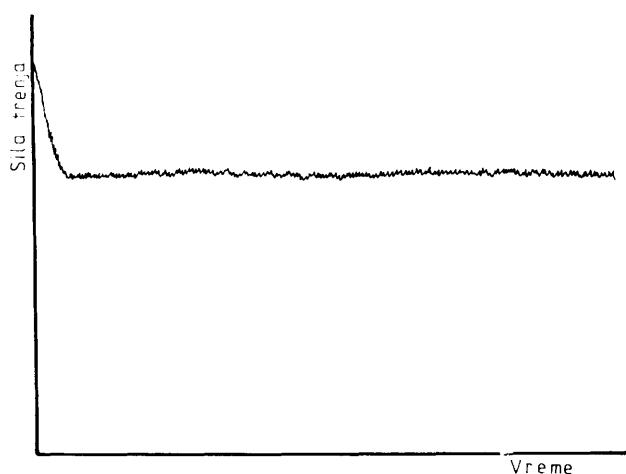
Sl. 10. - Zapis sile trenja (odgovara površini dobijenoj bez SHP, pri  $V_r = 13,8 \text{ m/min}$  i  $d = 0,06 \text{ mm}$ )
