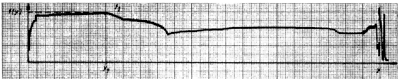
Sl. 1. - Tangencijalna komponenta sile rezanja u 1. partiji
