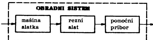
Sl. 1. - Rezni alat kao pod sistem u okviru pouzdanosti obradnog sistema
