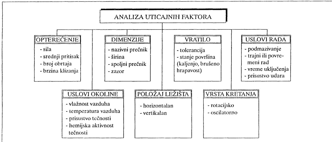
Sl. 2. Klasifikacija uticajnih faktora za ispravnu konstrukciju kliznog ležišta od termoplastičnih masa
