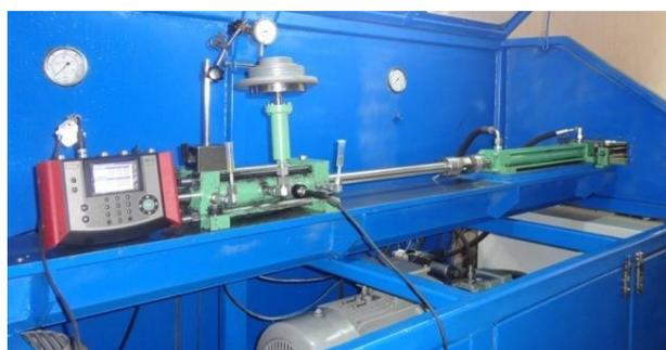
Fig. 1(a) Seal Test Rig.
